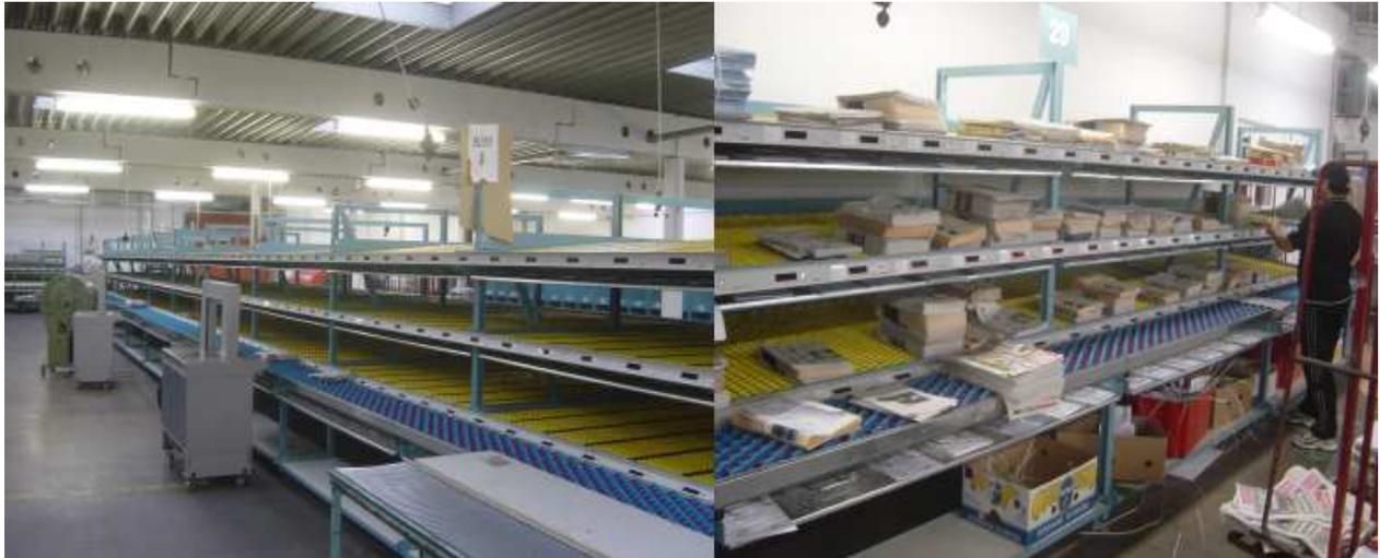
Pickline ist ein EPK-System, d.h. die Ware wird in die Fächer hineingezählt. Die Kundenpakete entstehen also in den Regalen, Module genannt. Die oben abgebildeten Module sind 21 m lang und verfügen über drei Ebenen. Über Konfigurationsprogramme werden die Touren und damit die Kunden den Displays zugeordnet.
